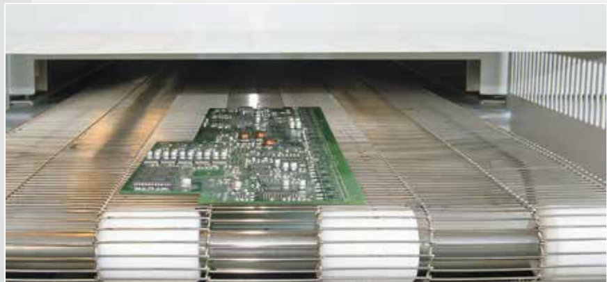
Stabsgeflechtband in Lötöfen.
