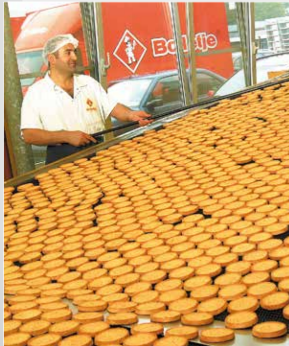
Spiralgeflechtsbänder sind geeignet für schwere, aber auch für sehr leichte Produkte.
