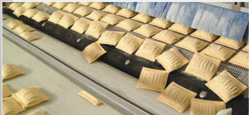
Drahtösgliederband im Gefriertunnel bei Bakkersland, Hoogeveen, Holland.
