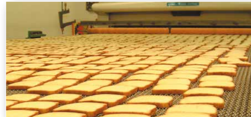
Spiraldrahtband im Backofen bei Bolletje, Almelo, Holland
